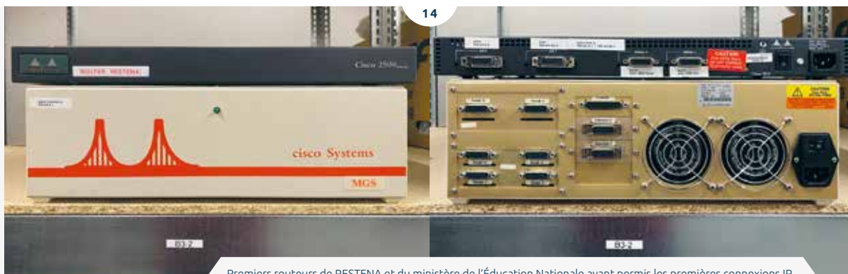
Premiers routeurs de RESTENA et du ministère de l'Éducation Nationale ayant permis les premières connexions IP (face avant, face arrière) // The first routers used by RESTENA and the Ministry of National Education, enabling the first IP connections (front, back)
